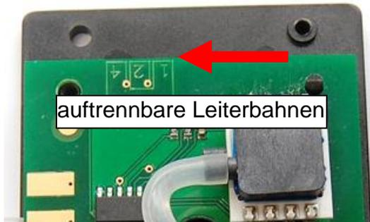
Die Festlegung der **Adresse** wird am Adapter durch Auftrennen von Leiterbahnen - gekennzeichnet mit den Zahlen (1), 2 und 4 – erreicht. Diese befinden sich auf der kurzen Platinkante in der Nähe des eigentlichen Drucksensors. Dem Adapter ist ohne Auftrennen von Leiterbahnen die Adresse 1 zugewiesen (Werkseinstellung). So lange keine weiteren Sensoren am DL-Bus liegen, ist auch keine Änderung der Adresse erforderlich.
