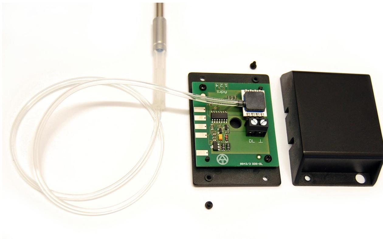
Der Drucksensor DDS-DL basiert auf dem Prinzip zweier zueinander um 90° verdrehter Silizium- Membrane, die sich im Differenzdruck durchbiegen. Der in Folge der Durchbiegung verändernde ohmsche Widerstand wird als Messgröße erfasst. Der Versatz der Membranen zueinander garantiert auch bei geringstem Druck eine Lage- unabhängige Signalpräzision.
