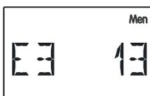
Hier wurde dem externen Sensor **E3** der Sensorwert der **Adresse 1** mit dem **Index 3** zugewiesen, das ist der Differenzdruck-Mittelwert 64 Sekunden.
