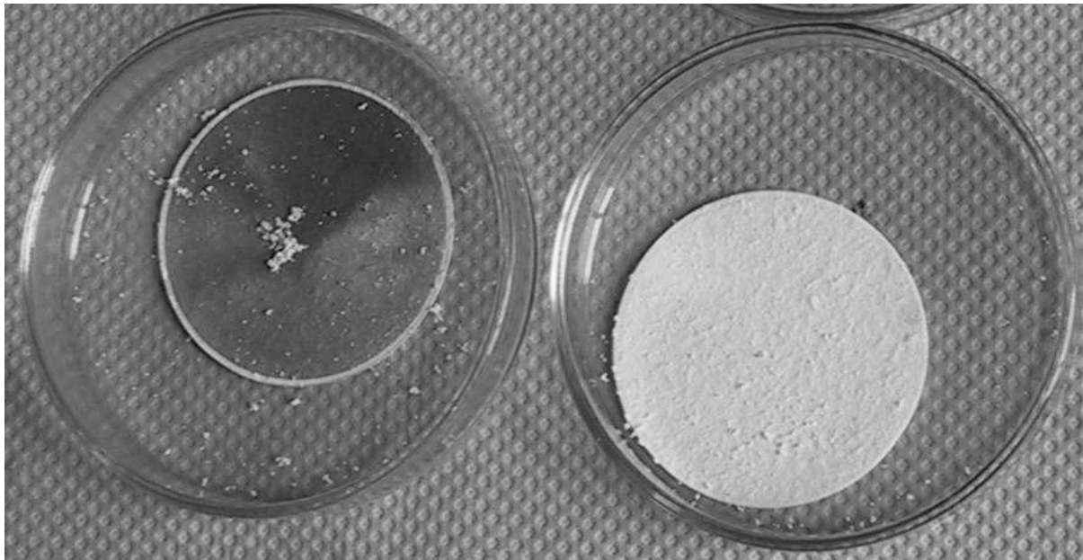
Abbildung 12: Abgelöste Partikel aus den Quarzfaserhülsen, auf einem Planfilter abgeschieden
