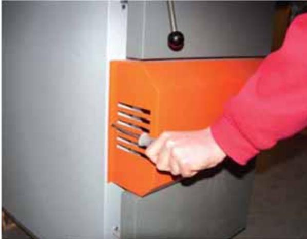
Die beiden Schrauben der Ventilatorabdeckung lösen und Ventilatorgehäuse abnehmen.
