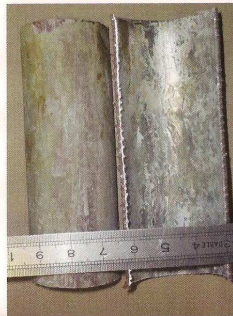
Abb. 4: Das Innemrohr lässt sich einfach abheben, weil die Verankerungen sind sichtbar.
