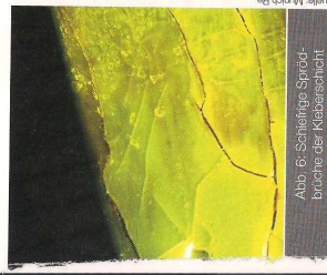
Abb. 6: Schiefelige Spaltbrüche der Klebarschicht
