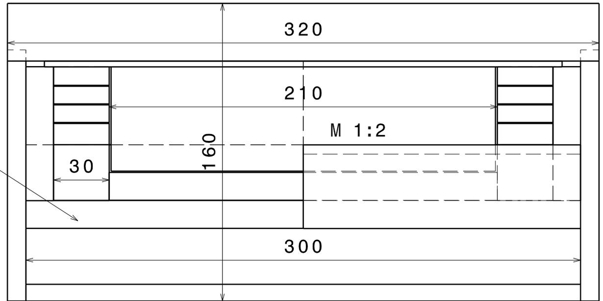
die Deckleiste wird nach dem Füllen des Formbodens aufgeschraubt danach wird die Form ganz aufgefüllt
